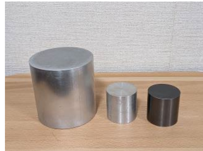
\Phi 80 \times 80 のアルミ， \Phi 40 \times 40 のアルミとタングステン（高増潔作成©takamasu-lab）
